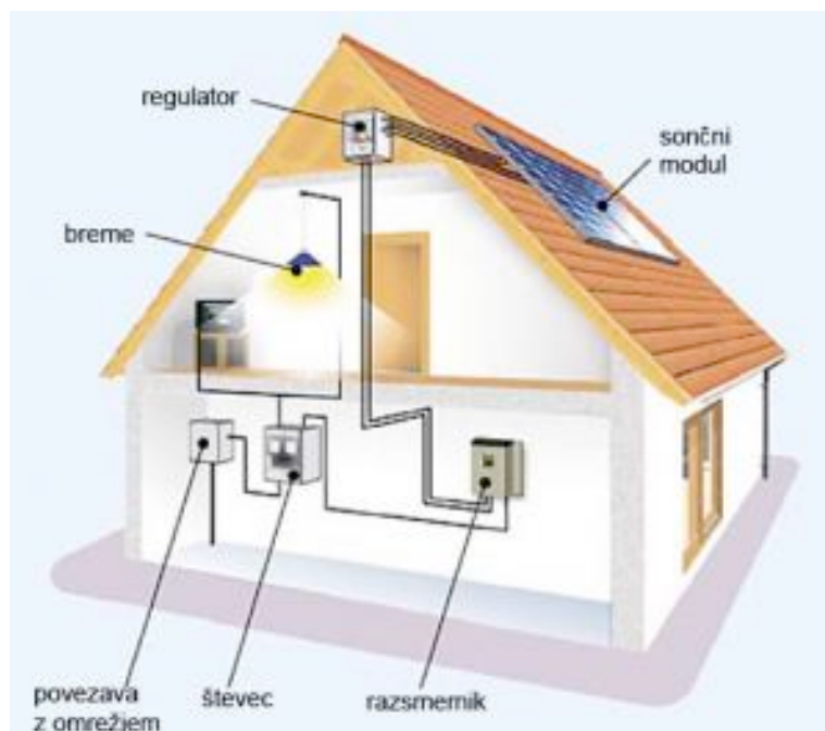
Slika: Elementi sončne elektrarne za gospodinjstvo
