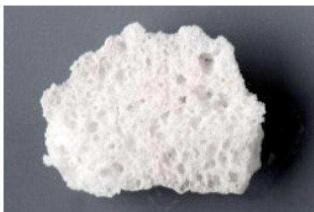
Slika: Lahek agregat na osnovi odpadnega stekla Vir: http://www.zag.si/si/index.php?nav0=home&nav1=novice&id=155
