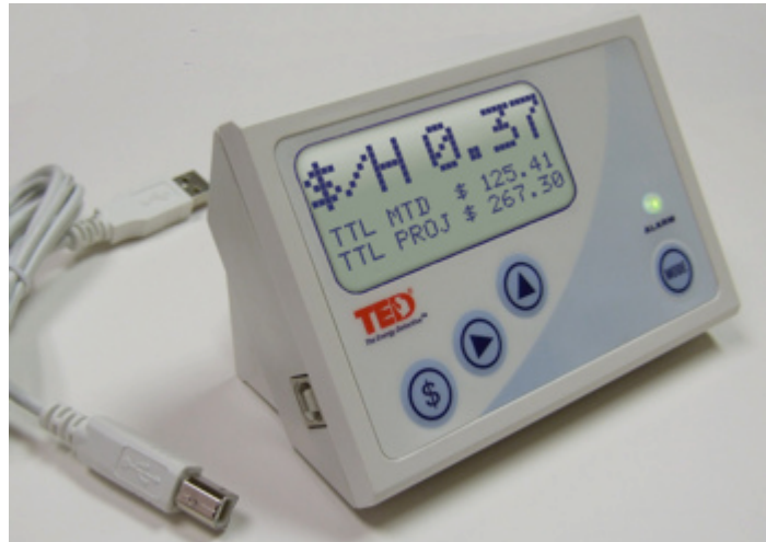
Slika: Merilec, ki kaže trenutno porabo el. energije Vir: http://en.wikipedia.org/wiki/Home_energy_monitor
