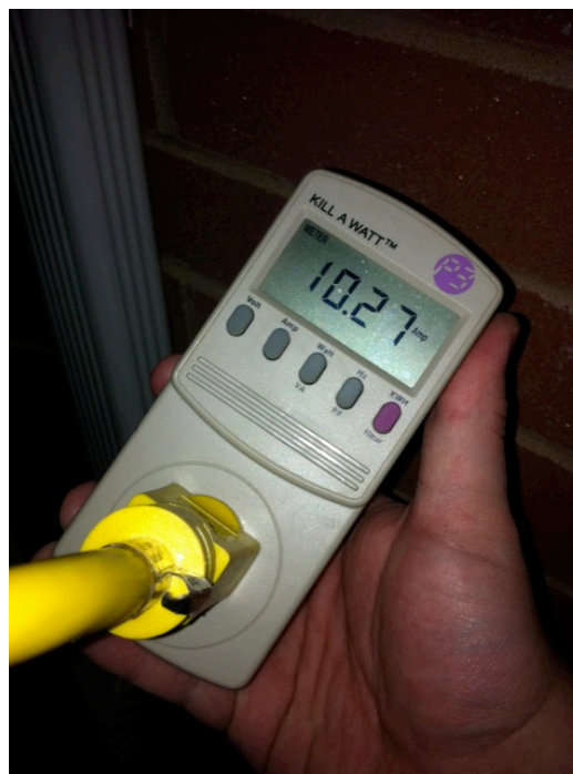
Slika: Merilec dosedanje mesečne porabe in stroškov zanjo (kill-a-watt) Vir: http://en.wikipedia.org/wiki/Kill_A_Watt
