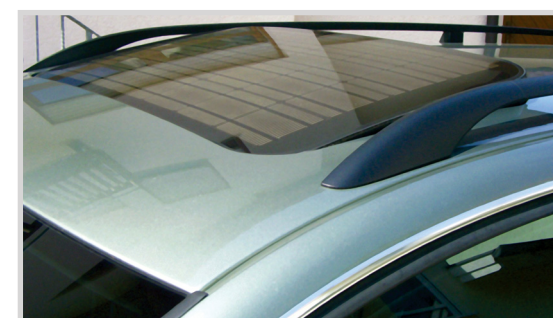
Sončna streha, uporabljena za klimatizacijo vozila
